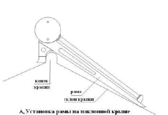
А. Установка рамы на наклонной крыше
