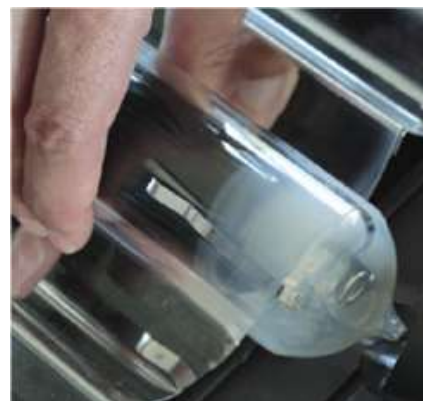
газопоглотитель разрушен, трубка неисправная
