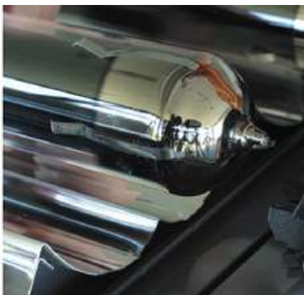
газопоглотитель в порядке, трубка исправная
