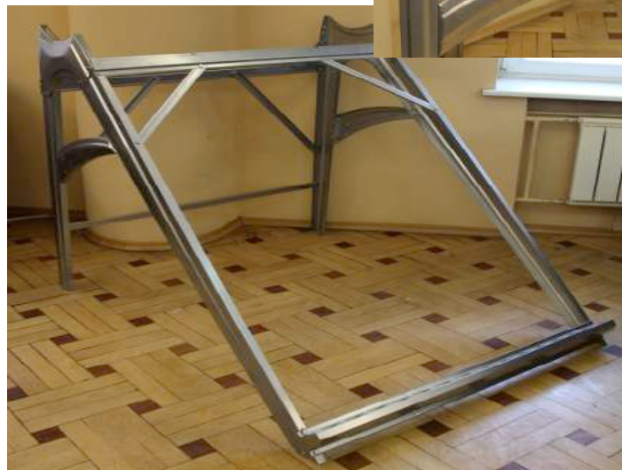
Конструкция стальной рамы → (к окрашенному баку)
