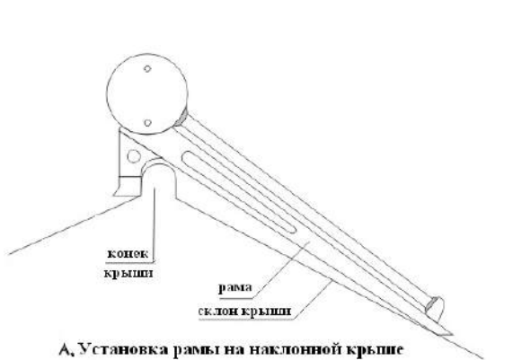
А. Установка рамы на наклонной крыше
