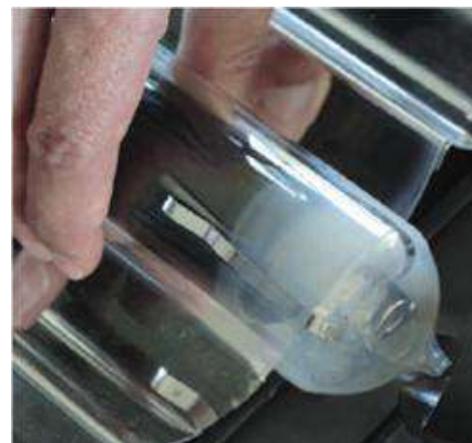
газопоглотитель разрушен, трубка неисправная
