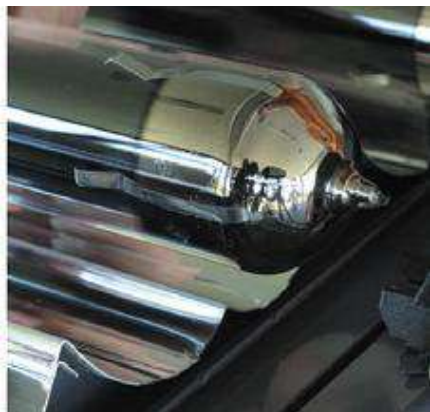
газопоглотитель в порядке, трубка исправная
