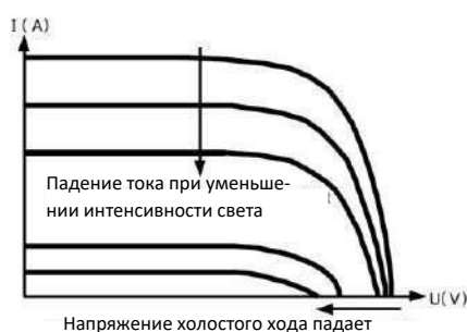
Рисунок 1-3. Зависимость выходных параметров модуля от освещенности
